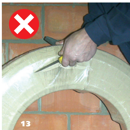
Разрезать упаковочные ленты ножом не рекомендуется во избежание повреждения трубы
