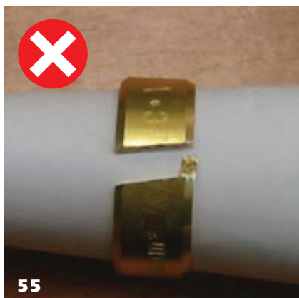
«Сухарь» на разрезе не должен иметь заусенцев
