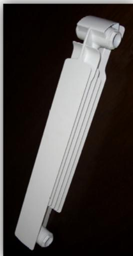
Окраска секций происходит отдельно методом напыления порошковой эмали цвета RAL9010 в электростатической камере с предварительной химической и физической обработкой.
